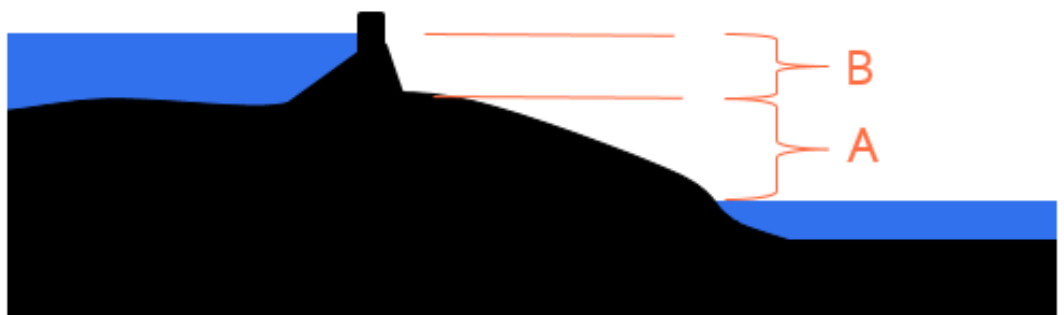
Kuva 5 Vanhan uoman poikkileikkaus ja energianmenetyksen luokat A ja B.
